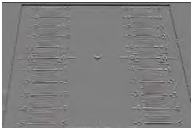
Imagen con microenfoque en +10: Bastante arreglado (el ajuste fino me sugería +12)
