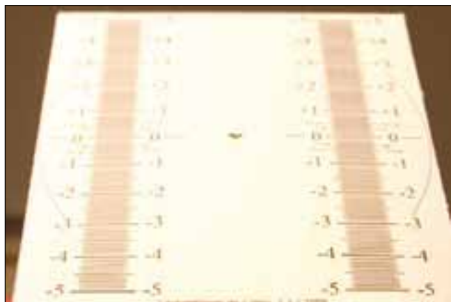
Imagen original: Como se puede apreciar, un frontfocus brutal...
