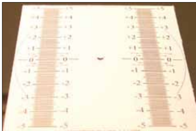
Imagen con microenfoque en +10: Bastante arreglado (el ajuste fino me sugería +12)
